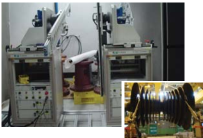
Wheel / Bucket Dovetail 등, 회전체 자동탐상장치
